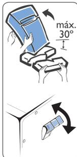
En la parte trasera del refrigerador retire las cintas adhesivas y destrabe los dos distanciadores traseros. Déjelos en la posición horizontal.
