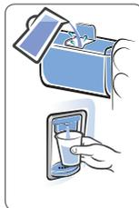
Este procedimiento debe repetirse para cada cambio del refil (elemento filtrante). Se recomienda el cambio del refil a cada 6 meses. Para adquirir este refil procure un servicio técnico o una tienda Electrolux.
